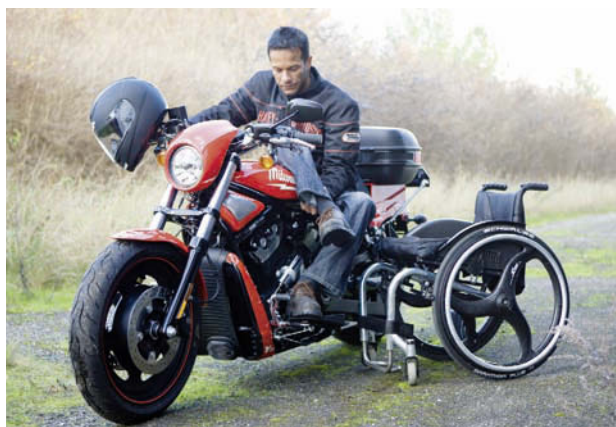
Der Umbau umfasste u.a. die Umstellung auf Handbetrieb, den Einbau eines elektropneumatischen Stützfahrwerks sowie des Feedless Biking Systems (auf Knopfdruck fahren innerhalb von einer Sekunde die Stützräder heraus).
